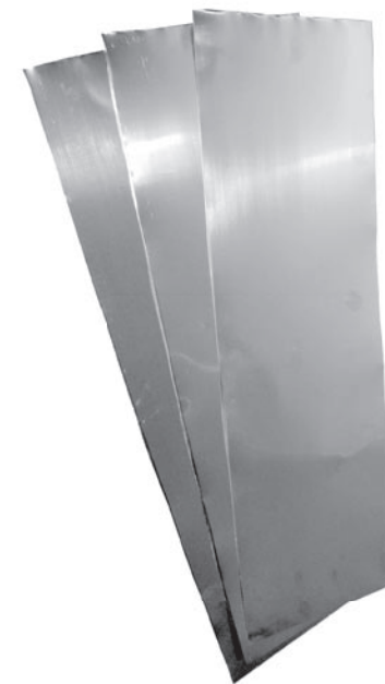
Sl: Limena krilca pripremljena za savijanje
